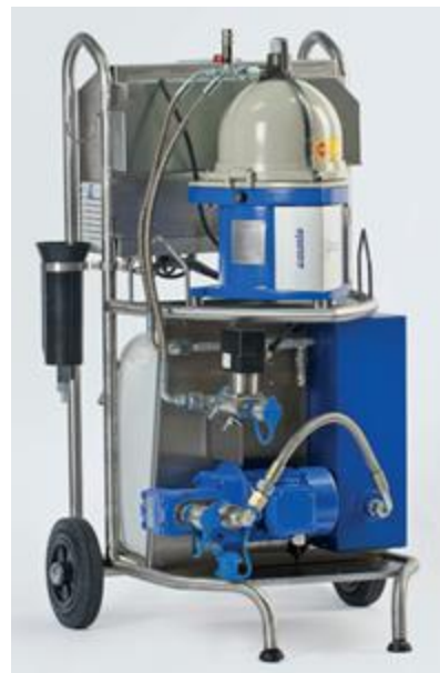
Figura 2 centrífuga portátil para até 1m 3 /h
